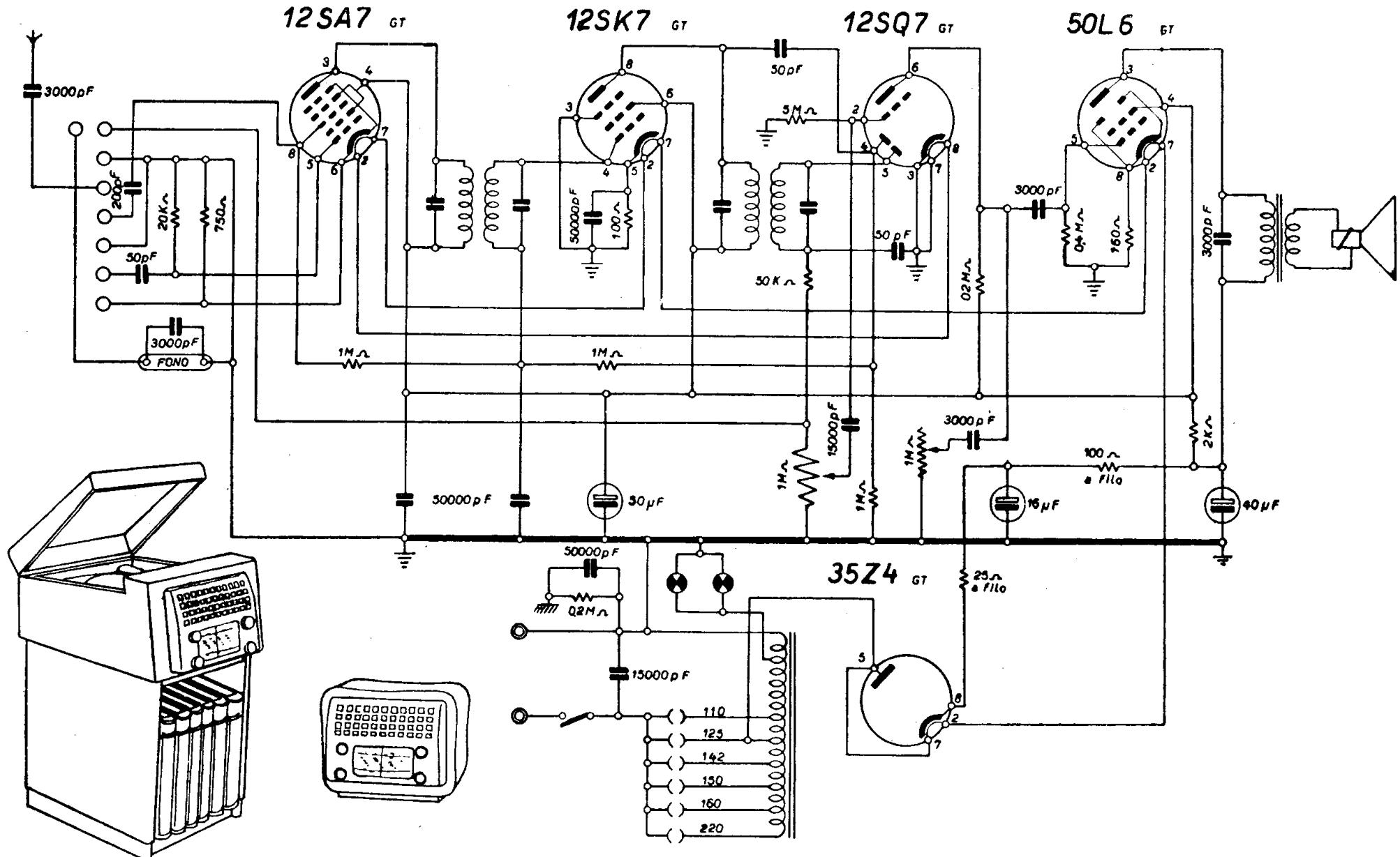
REOM - Sintomagic Radio modelli a1 ed a2 - Il mod. a2 è provvisto di fonografo elettrico. Gamma onde medie divisa e due bande onde corte. Media frequenza 470 kc. Controllo di tonalità.
